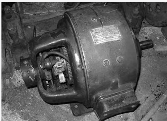
Motore per corrente continua, costruzione Marelli, 3,6 HP, tensione alim. 115 V – databile anni '20 (Per gent. conc. Santini Lino)
